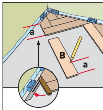
При установке последней доски, выполните измерения (a) и отметьте на доске с маркировкой «B»
