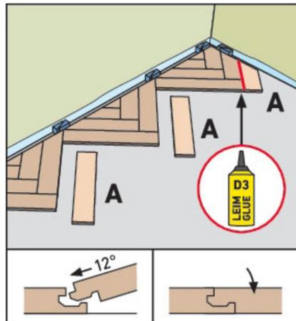
При укладке следующего ряда двигайтесь в направлении слева направо. Установите доски с маркировкой «А» справа от каждого перевернутого треугольника и защелкните их в замок.
