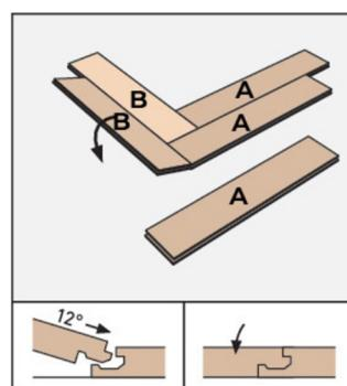
Возьмите вторую доску с маркировкой «B», поместите ее слева от V-образной конструкции и защелкните ее в замок.
