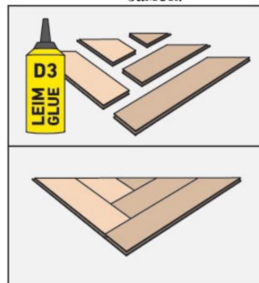
Таким образом у вас получится перевернутый треугольник. Разъедините доски, нанесите клей на места стыков и соедините их вместе, чтобы получить более прочную конструкцию.
