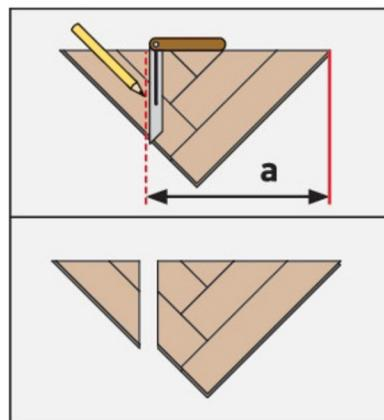
При установке у стены, расположенной слева, определите расстояние (a), отметьте его (справа налево) на перевернутом треугольнике и отпишите. При установке у стены справа отметьте линию (слева-направо) и отпишите.
