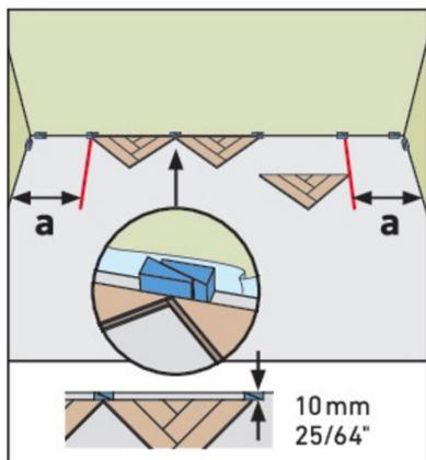
Начинайте укладку пола от центра задней стены, продвигаясь вперед; установите получившиеся у вас перевёрнутые треугольники. Убедитесь в том, что между боковыми стенами и задней стеной оставлен 10 мм зазор.
