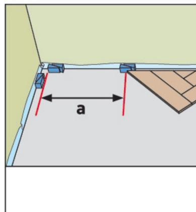
Для того, чтобы установить последние перевёрнутые треугольники у левой или правой стены, в первую очередь необходимо измерить расстояние (как показано на рисунке (a)). Помните, что между стеной и ламинатом должен быть оставлен 10 мм зазор.
